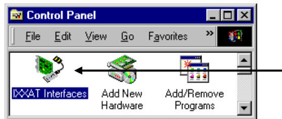
Bild 4-1: Das IXXAT Interfaces Applet im Control Panel
